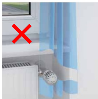
Špatně: Termostatická hlavice s vestavěným čidlem nesmí být skryta za záclonou.
